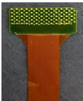
Рисунок 4. 64-полюсные пластинчатые электроды, используемые для эпикардialного картирования левого предсердия («Биоток», Россия).
