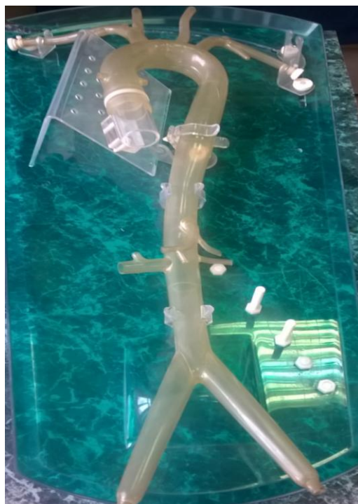
Рисунок 3. Макетный образец модели аорты с магистральными ветвями
